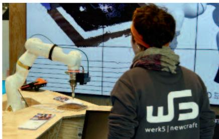
*Ein Roboterarm bei Fräsarbeiten: In einem Handwerksbetrieb aus Berlin arbeiten die Beschäftigten mit kollaborativen Robotern, kurz Cobots, zusammen, die eine Art dritter Arm für den Handwerker werden könnten.*
