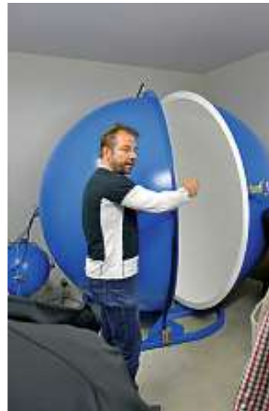
Ein Ingenieur der Firmengruppe "Licht-Jahre voraus" erklärt, wie anhand einer Ulbricht-Kugel, der Lichtstrom und die Strahlungsleistung gemessen werden können.
